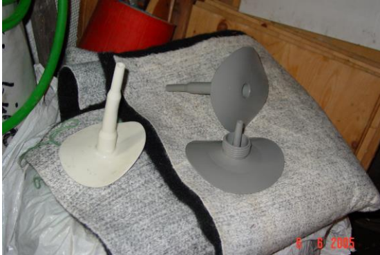
Tubería de inyección
